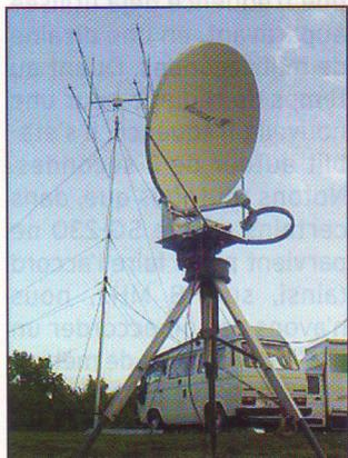
1 - Une parabole sous le H des antennes 432 MHz.
